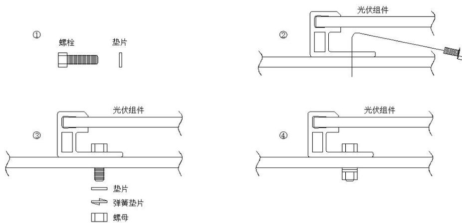
图5 螺丝安装
