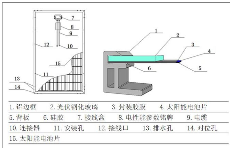
图 3 联塑班皓光伏组件结构
